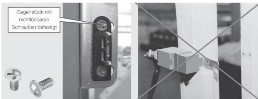
Abb. 1: Manipulierte Schutzeinrichtung mit demontiertem Betätiger
