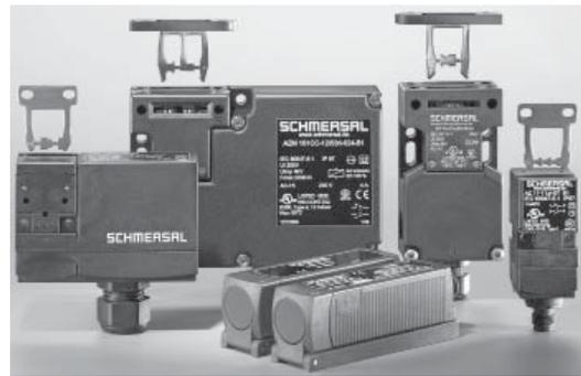
Abb. 4: Sicherheitsschaltgeräte der Bauart 2, wie sie oft an trennenden beweglichen Schutzeinrichtungen zur Stellungsüberwachung verwendet werden (Quelle: K. A. SCHMERSAL GMBH)
