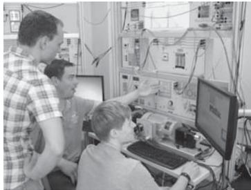
Abb. 2: FST-Schüler diskutieren Messwerte einer Windenergieanlage mit doppelt gespeister Asynchronmaschine
