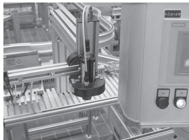
Abb. 7: Abstandsmesssystem auf Mikrocontrollerbasis mit Laserdistanzsensoren zur Erfassung von Verpackungsabmessungen, rechts: Kamerasystem zur Produktprüfung
