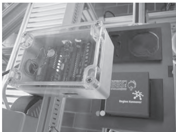
Abb. 7: Abstandsmesssystem auf Mikrocontrollerbasis mit Laserdistanzsensoren zur Erfassung von Verpackungsabmessungen, rechts: Kamerasystem zur Produktprüfung
