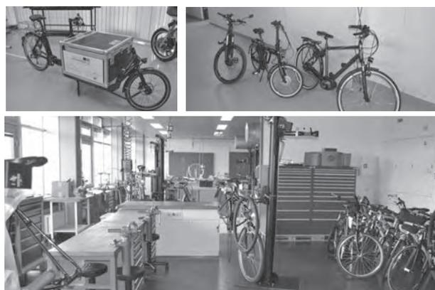
Abb. 1: Zweirad-Werkstatt mit Pedelec-Prüfstand und Pedelecs
