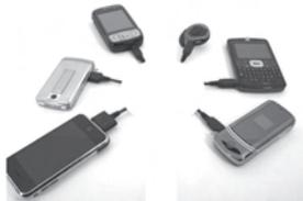
Abbildung: Jedes Mobiltelefon hat einen speziellen Anschluss (Quelle: public domain)
