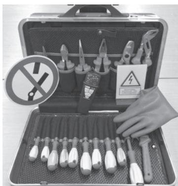
Abb. 1: Beispiel für spezielle Werkstattausstattung für die Arbeit an Hochvolt-Fahrzeugen und -Systemen im Kfz-Service Labor der Europa-Universität Flensburg (Foto: biat)
