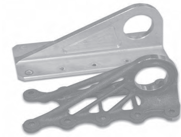
Abb. 1: Konventionell (oben) und additiv gefertigter (unten) Kabinenhalter für den Airbus A350 XWB (Quelle: CAVIEZEL u. a. 2017, S. 40; © Airbus Operations GmbH)
