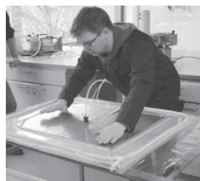
Abb. 1: Vakuuminfusionsverfahren erfordern viel Handarbeit und Genauigkeit
