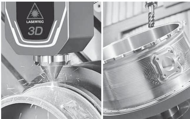
Abb. 1: Hybride Komplettbearbeitung: Additive Manufacturing (Auftragen des Pulvers auf die Oberfläche des Halbzeuges durch das Pulverdüseverfahren) und Fräsen auf einer Maschine (DMG 2018)
