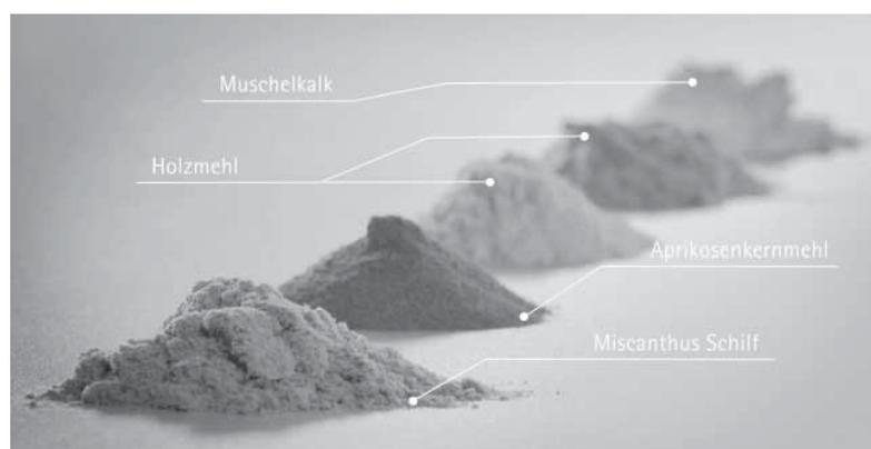
Abb. 6: Ausgangsmaterial für das 3D-Drucken [AMtopus GmbH & Co. KG]
