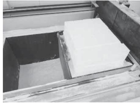
Abb. 3: Gedruckte Bauteile auf der Bauplattform vor dem „Auspacken“; links ist die leere Reservoirkammer sichtbar
