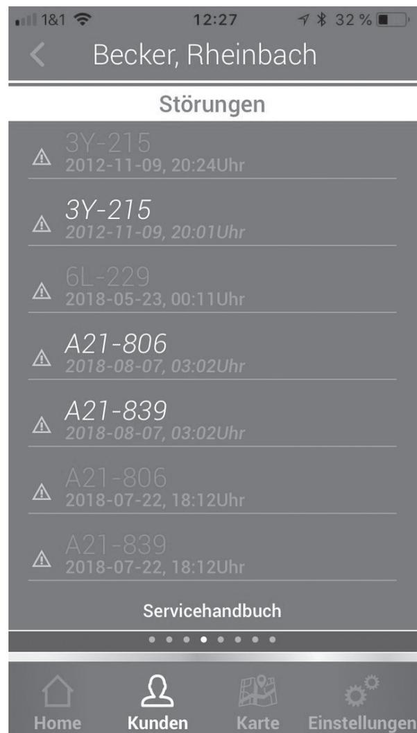
Abb. 5: Diagnose ausgehend von Online abgerufenen Störungscodes
