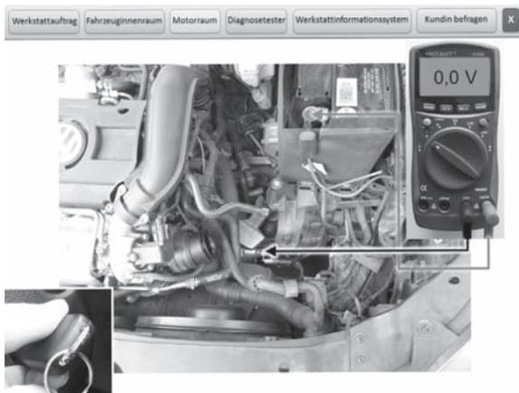
Abb. 3: Spannungsbefallmessung an der Starterhauptleitung
