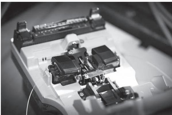
Abb. 2: Einlegen der Fasern in das Spleißgerät
