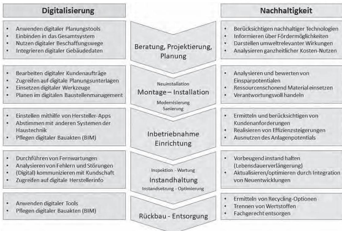
Abb. 3: Digitalisierungs- und Nachhaltigkeitsbezug in Arbeitsprozessen im Handwerk SHK
