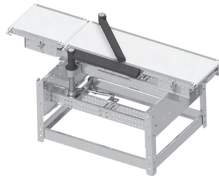
Abb. 8: Absenkbare Weiche in Arbeitsstellung
