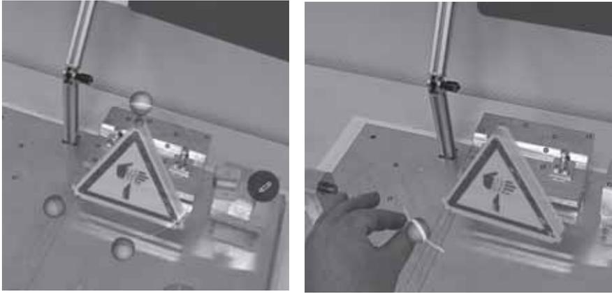
Abb. 6: Positionierung von Warnhinweisen mittels der AR-Brille
