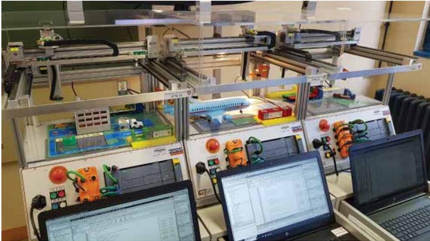
Abb. 2: Interagierende, über Profinet verbundene Lernträger
