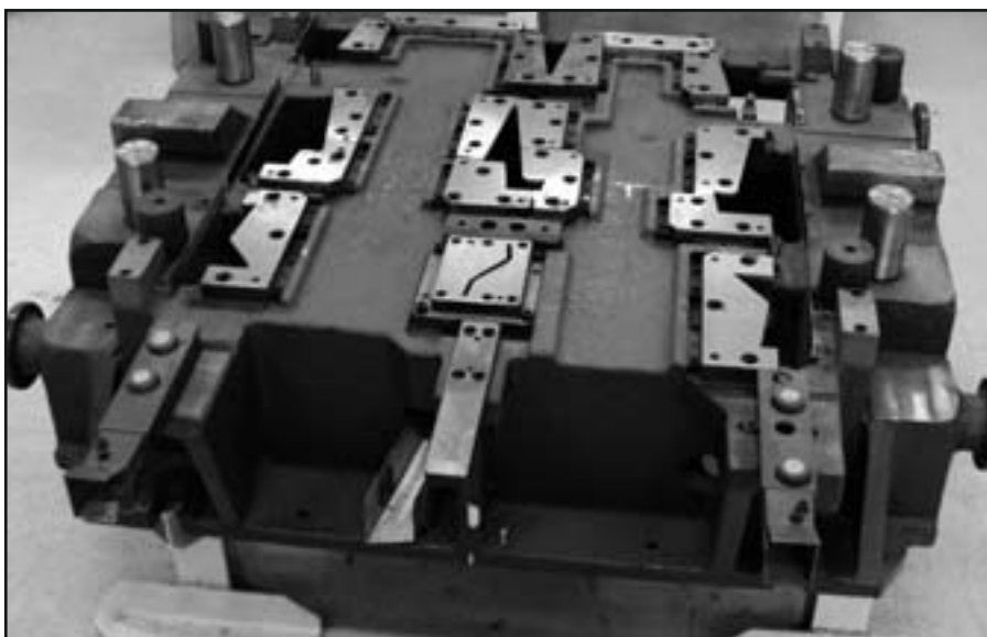
Abb. 2: Beispiel eines „Trainingswerkzeuges“ (Unterteil eines Großschneidwerkzeugs aus der Automobilindustrie)
