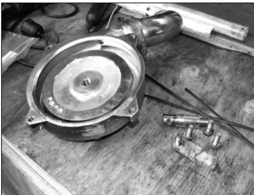
Abb. 5: Bruch der Welle einer Kühlmittelpumpe
