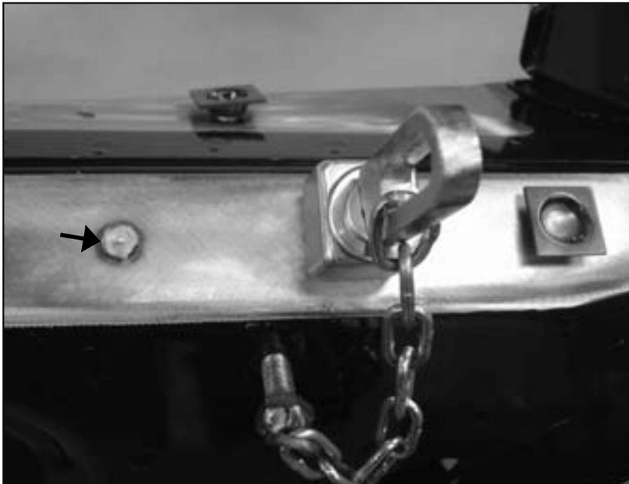
Abb. 2: Rückverformung unter Verwendung von Zugblechen
