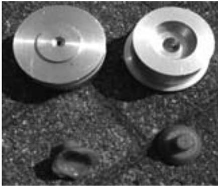
Abb. 8: Spritzgussform (CNC-Dreh-
