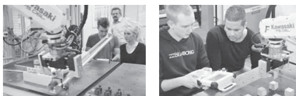
Abb. 7/8: Auszubildende teachen den Roboter und kontrollieren den Programmablauf im Teachmodus (FOTOS: TRÖLLER)
