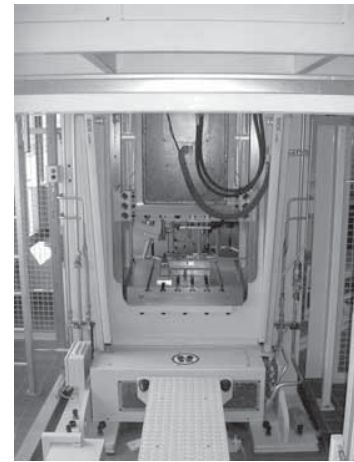
Abb. 4: 7. Achse und Hydraulikpresse am Ende der Anlage – Station 1 (Foto: TRÖLLER)
