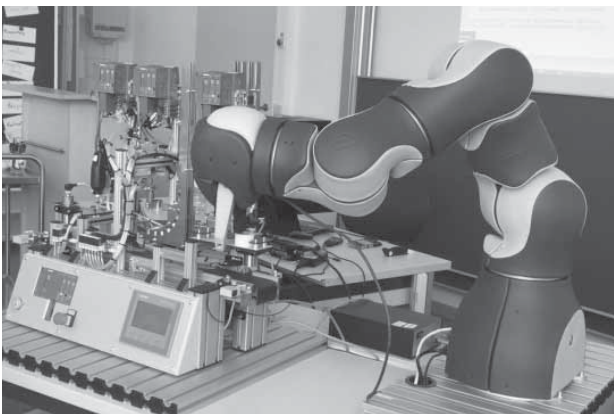
Abb. 1: „P-Rob 2“ in Kombination mit einem MPS-Transfersystem „Industrie 4.0“ (Foto: biat)
