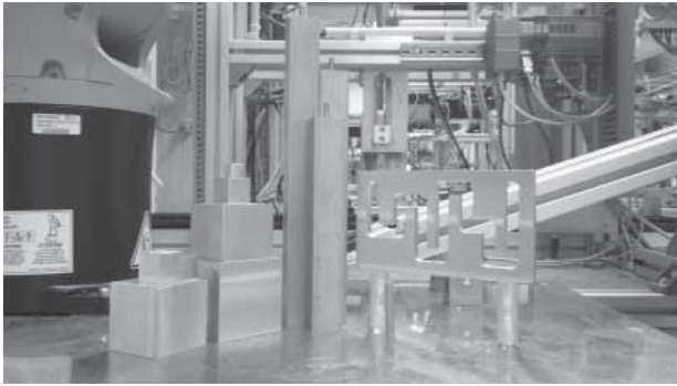
Abb. 5: Unterschiedliche Werkstücke zum praktischen Erlernen des Verfahrens mit dem Roboter (Foto: BBS 2 Wolfsburg)
