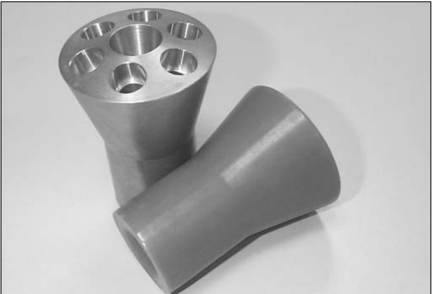
Abb. 5: Expansionsventil (stehend: spanend hergestellt, liegend: Rapid-Prototyping-Modell als Wachsmodell für den Feinguss)
