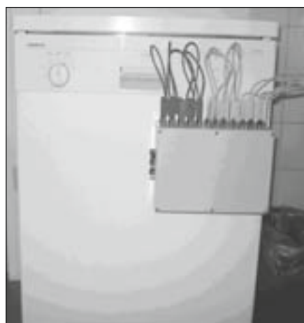
Abb. 10: Umgebauter Geschirrspüler mit externer Anschlussbox zur Signalanalyse
