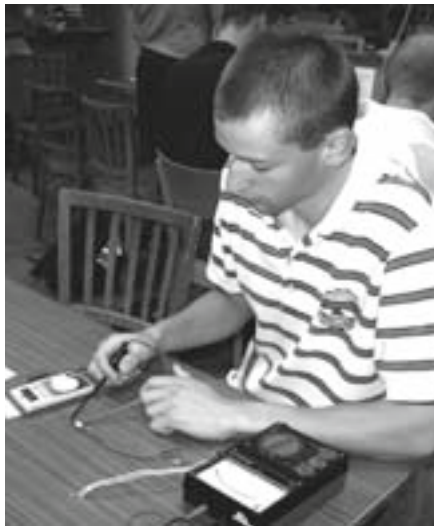
Abb. 3: Schüler beim Messen der Widerstände von Temperaturfühlern
