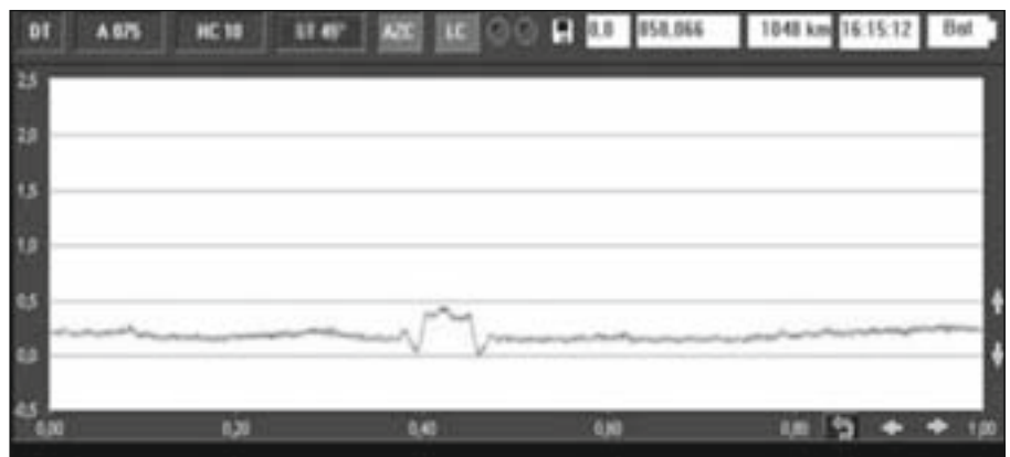
Abb. 14: Wirbelstromanzeige nach dem Schleifen mit Schweißnaht
