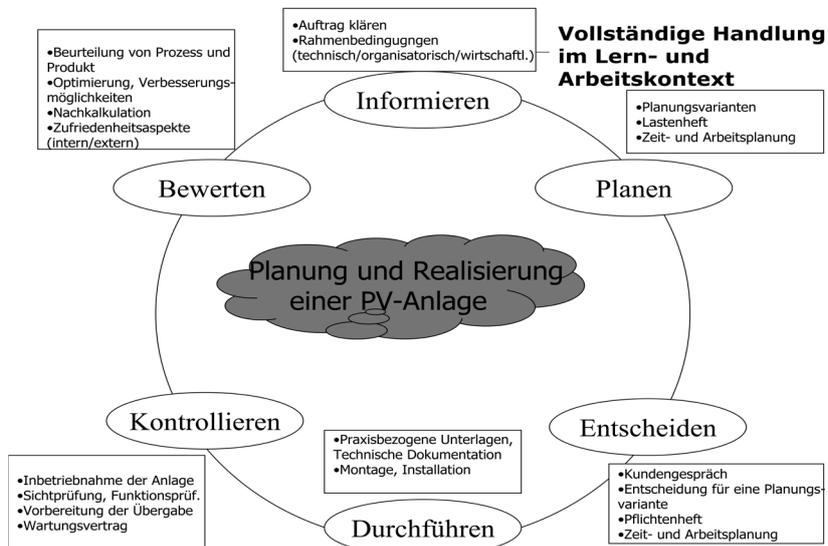
Abb. 7: Vollständige Handlung im Lern- und Arbeitskontext am Beispiel des Kundenauftrags „Planung und Realisierung einer PV-Anlage“
